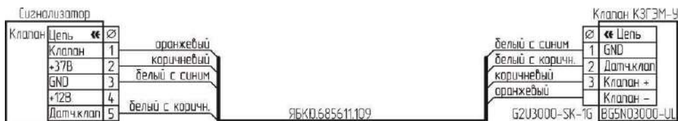
Рисунок В.4 – Схема подключения клапана КЗГЭМ-У с разъемом BG5NO3000-UL.
