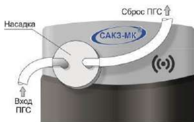
Рисунок Г.1 – Схема установки насадки
