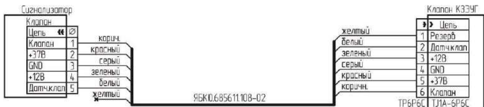
Рисунок В.6 – Схема подключения клапана КЗЭУГ с разъемом T1A-6P6C
